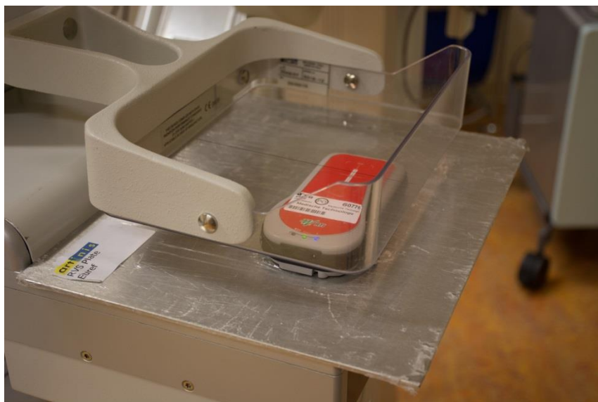
Figuur 4. Plaatsing van de dosimeter en RVS plaat voor de dosismeting.
