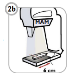
Figuur 6. Opstelling test buisspanning
