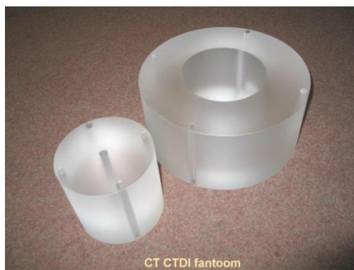
Fig. 12: Perspex CTDI fantoom. Links het head fantoom (diameter 16 cm), en rechts het body fantoom (diameter 32 cm).
