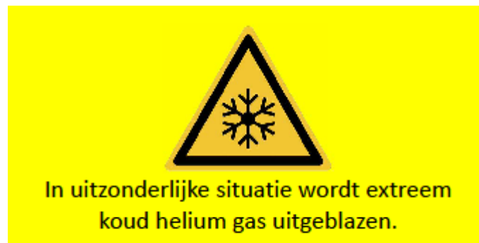
Figuur B5. Voorbeeld voor signalering bij de uitlaat van de quenchijs, met symbool uit de NEN-EN-ISO 7010 norm.
