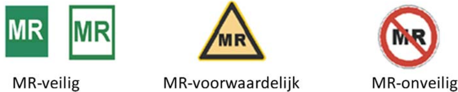
Figuur 6.1 symbolen voor classificering van implantaten, volgens de ASTM standaard.
