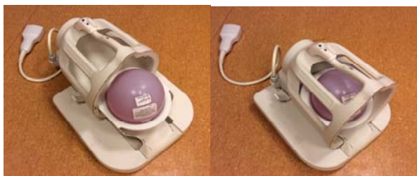
Figuur E.1. GE 8 kanaals hoofdspool met GE Top Level Test bol-fantoom voor QC
