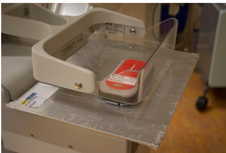
Figuur 4. Plaatsing van de dosimeter en RVS plaat voor de dosimetring.
