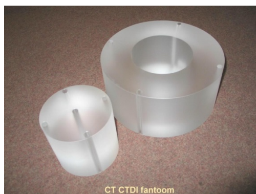
Fig. 12: Perspex CTDI fantoom. Links het head fantoom (diameter 16 cm), en rechts het body fantoom (diameter 32 cm).
