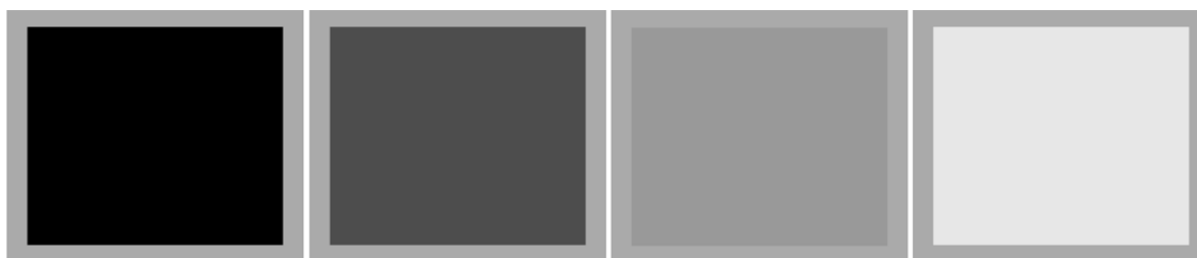
Figuur 3 Enkele TG18-LN12 testpatronen. De helderheid van het vierkant verschilt per testpatroon (n.b. in het originele testpatroon is de uniforme achtergrond veel groter). Van links naar rechts: TG18-LN12-1, TG18-LN12-5, TG18-LN12-10 en TG18-LN12-16.
