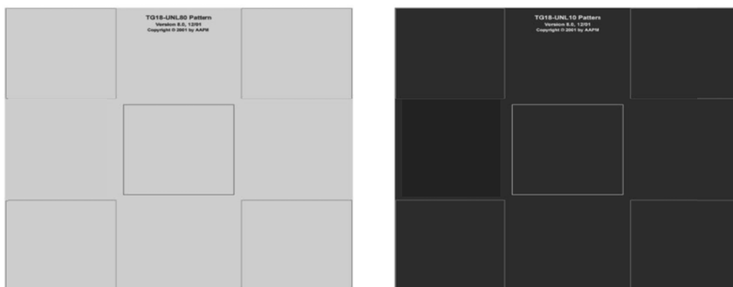
Figuur 4 TG18-UNL80 en TG18-UNL10 testpatroon met elk vijf vlakken.
