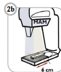
Figuur 6. Opstelling test buisspanning
