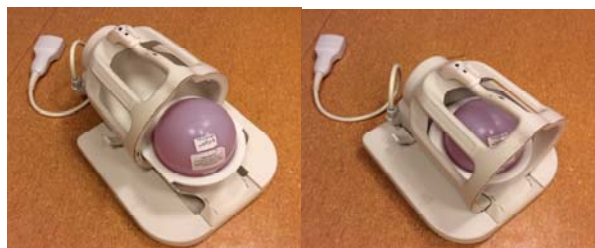
Figuur E.1. GE 8 kanaals hoofdspool met GE Top Level Test bol-fantoom voor QC
