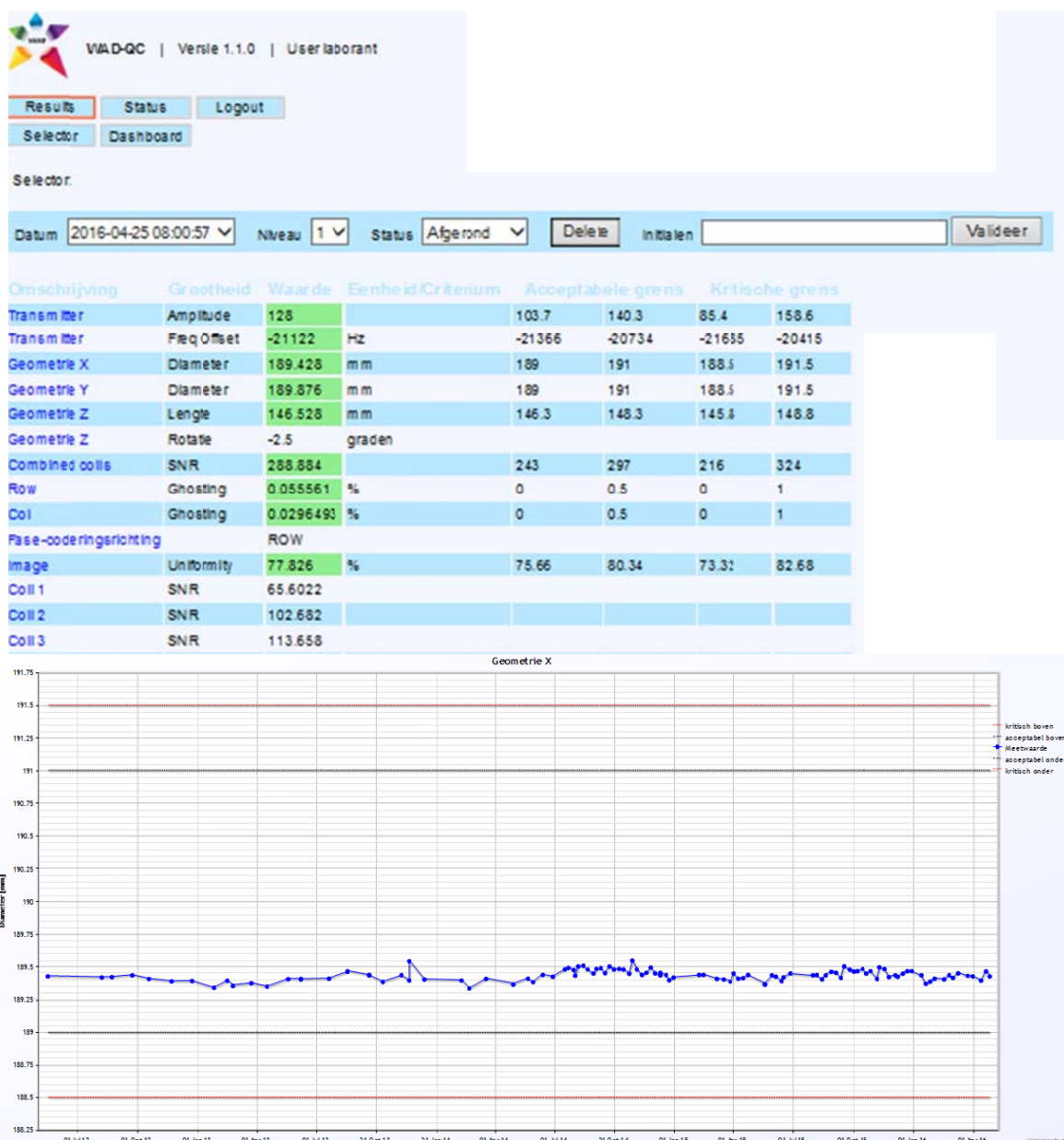
Figuur B4. Voorbeeld van resultaten overzicht gegenereerd door de WAD software, met bijbehorende grafiek van verloop van de resultaten in de tijd.
