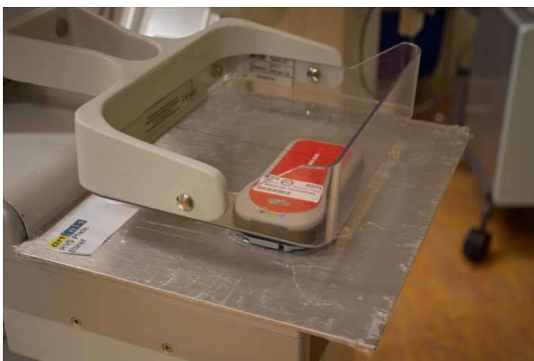
Figuur 4. Plaatsing van de dosimeter en RVS plaat voor de dosimetrie.
